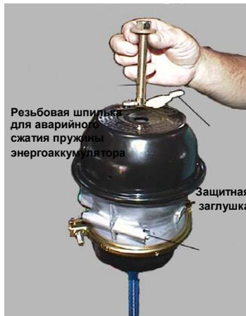
Резьбовая шпилька для аварийного сжатия пружины энергоаккумулятора
