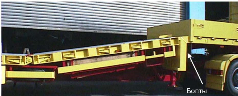
Управляющий клапан для подъема или опускания пандуса находится с правой стороны полуприцепа, на пульте управления. В дорожном положении пандус следует перевести в опущенное или поднятое положение и вручную закрепить болтами. Опускать и поднимать пандус можно только в **разгруженном** состоянии, при отсоединенных болтах. Если по пандусу предполагается движение техники массой более 3 т, пандус необходимо механически закрепить болтами.
