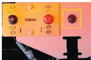
Ручное опускание оси
