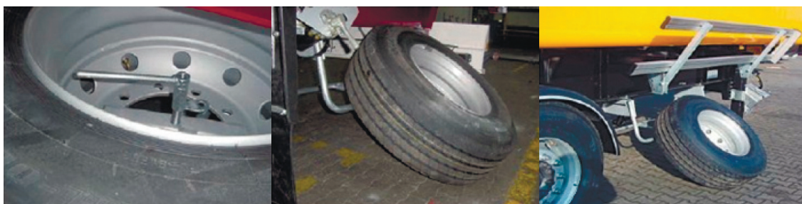
Отвинтить гайку винта, держащую зап. колесо
