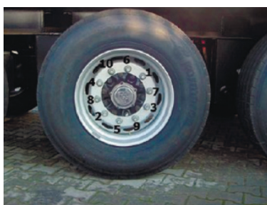
Порядок крепления зап. колеса
