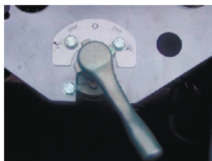
Ручной подъем и опускание кузова, подъем кузова (А)
