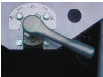
Ручной подъем и опускание кузова, положение STOP
